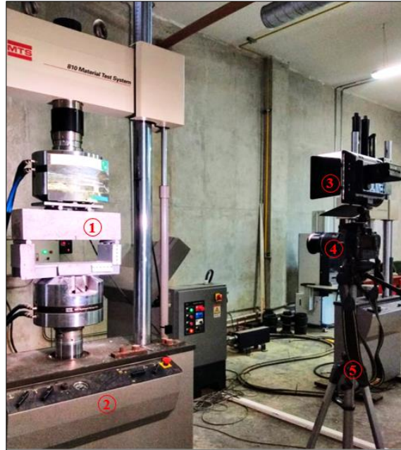
Figura 3. Montaje experimental CID (1) Espécimen de estudio (2) Máquina de ensayos (3) Luz (4) Cámara (5) Trípode.
