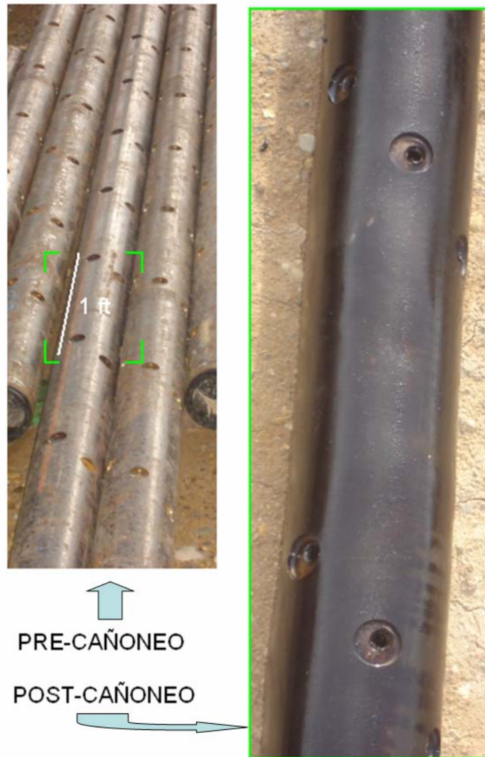
Figura 15, Tubería de cañoneo.
