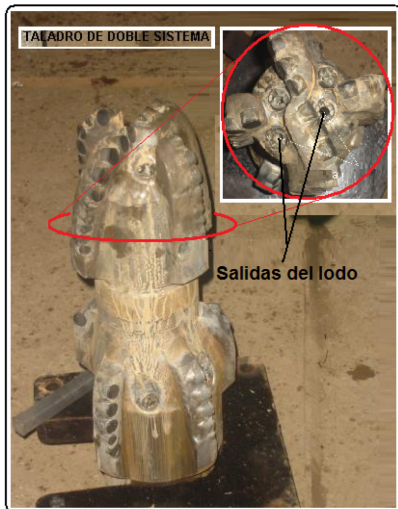
Figura 23, Broca y salidas del lodo de perforación
