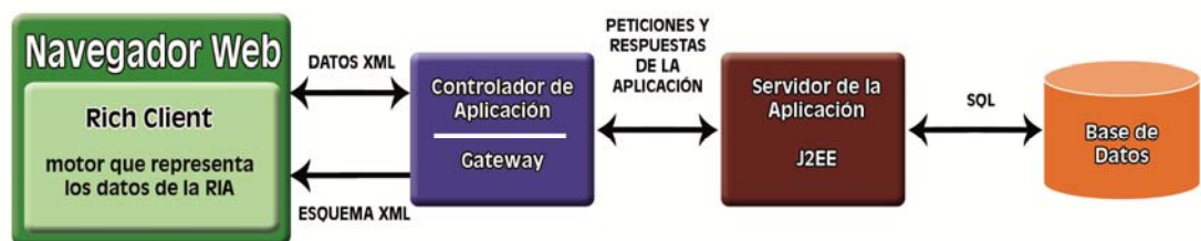
Figura 52. Estructura de una RIA
