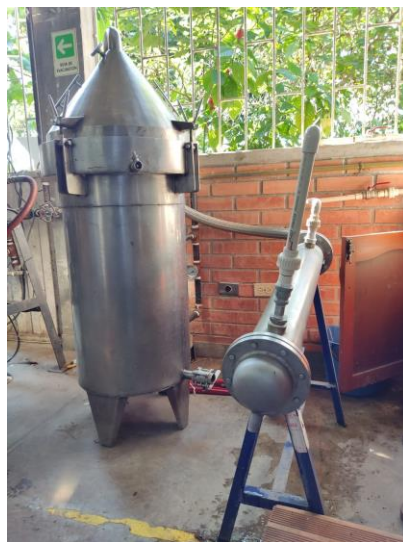
Figura 7. Montaje experimental para la obtención de los AE (alambique, condensador). Foto tomada por el autor Cesar Alberto Garcia Q. Fecha: septiembre 18 de 2021. Lugar: CENIVAM, UIS, Bucaramanga.
