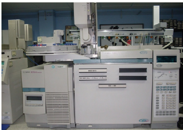
Figura 27. Cromatógrafo de gases Agilent Technologies 6890 Plus Series GC System acoplado a un detector selectivo de masas Agilent Technologies 5973 Network , equipado con un puerto de inyección split/splitless y un inyector automático Agilent 6890 . Se indica la programación de la temperatura del horno para análisis en la columna apolar. Foto: Camilo Durán, Laboratorios CIBIMOL-CENIVAM, marzo 2011.
