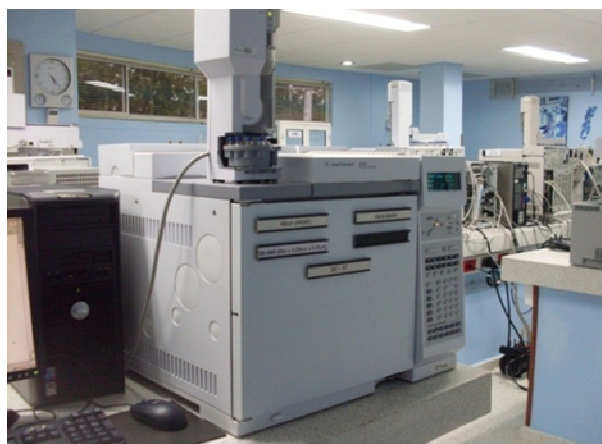
Figura 28. Cromatógrafo de gases de alta resolución Agilent Technologies 6890N , con detector de ionización en llama (FID). Foto: Camilo Durán, Laboratorios CIBIMOL-CENIVAM, marzo 2011.
