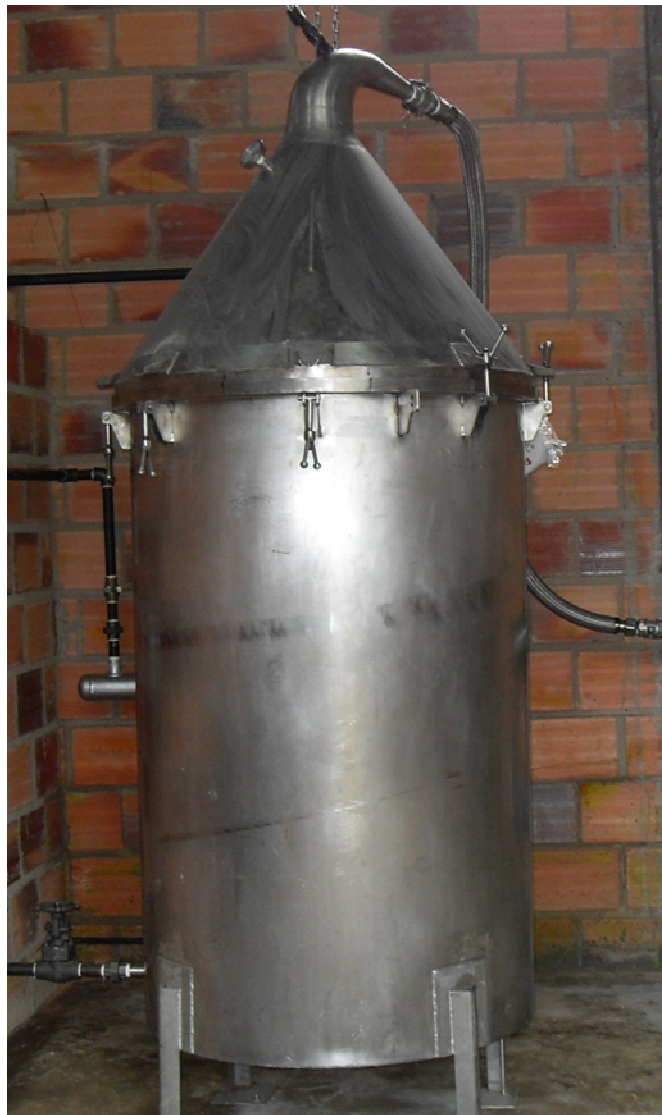
Figura 21. Destilador: Alambique y cuello de cisne instalado en el municipio de Sucre (Santander). Foto: Carlos A. Cárdenas, Noviembre de 2010.
