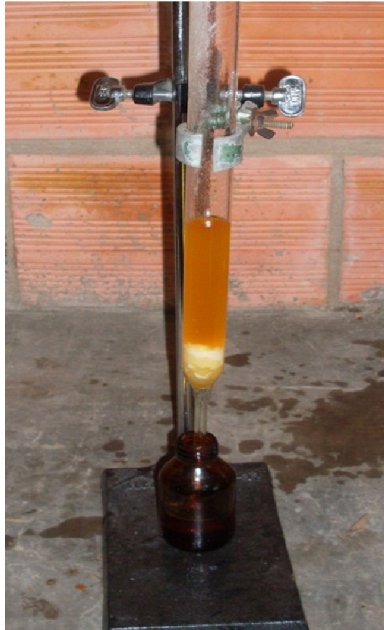
Figura 31. Filtración del aceite esencial de Thymus vulgaris L. en el municipio de Sucre (Santander). Foto: Víctor Pérez, Diciembre de 2010.
