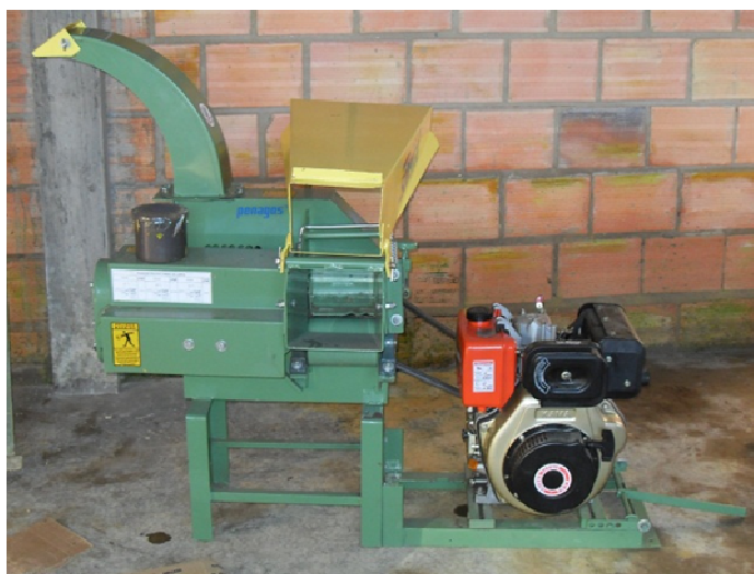
Figura 26. Picadora para material vegetal marca Penagos, referencia PE-800, instalada en el municipio de Sucre (Santander). Foto: Víctor Pérez, Noviembre de 2010.
