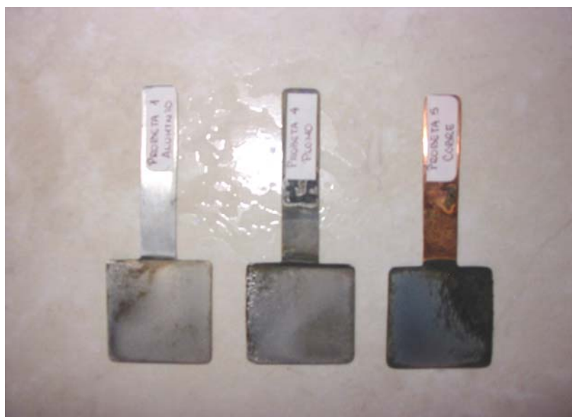
Figura 4.5. Recubrimientos obtenidos con el proceso 2 para Al, Pb y Cu, respectivamente
