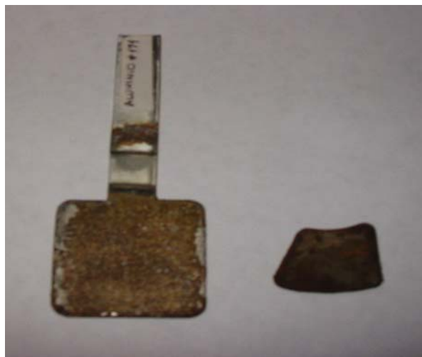
Figura 4.12. Recubrimiento obtenido en el proceso 2 e imán de \text{Nd}_2\text{Fe}_{14}\text{B} expuestos a condiciones atmosféricas durante 30 días.
