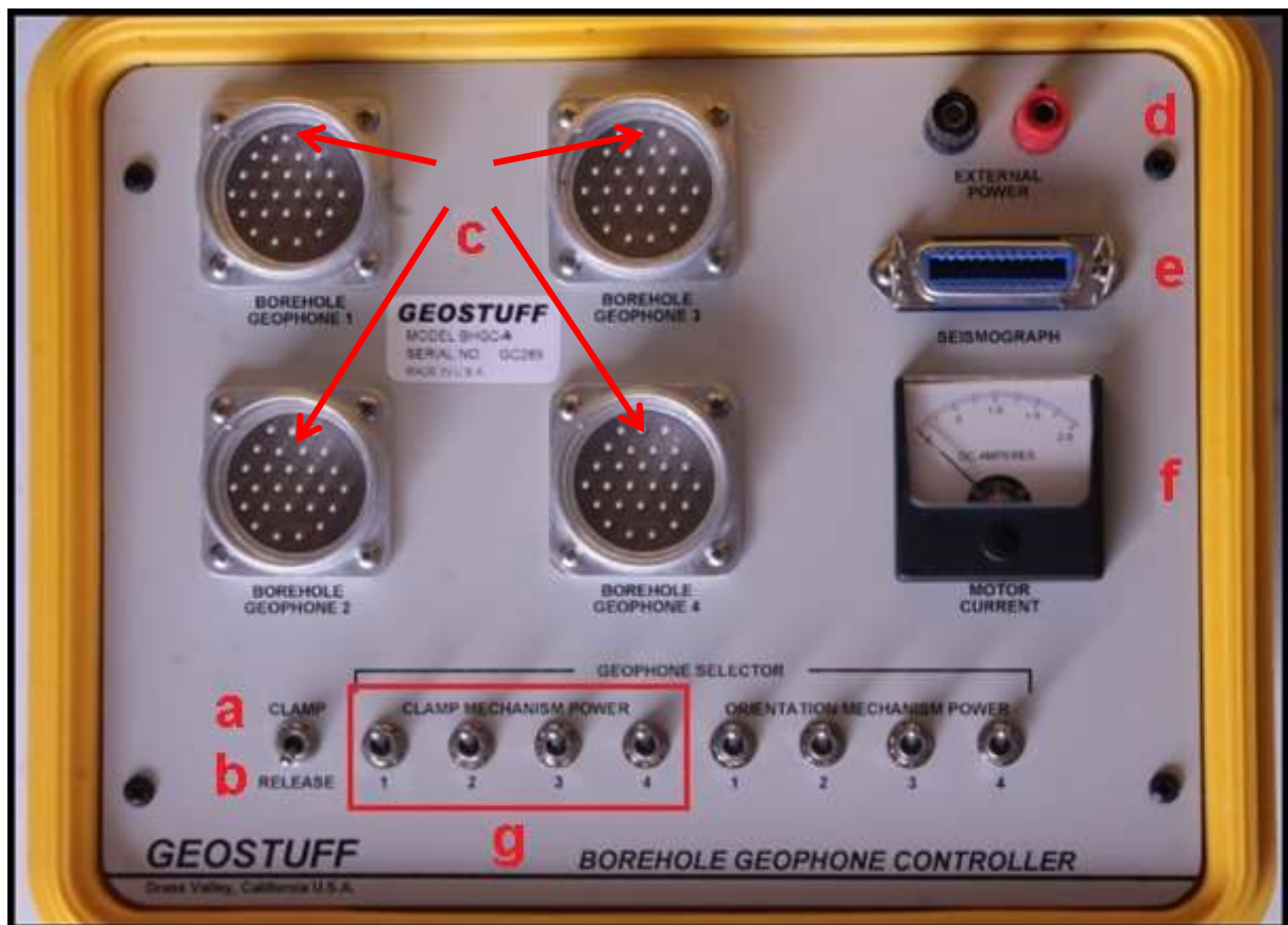
Imagen 13. Tablero de manejo Geostuff (BHGC-4)
