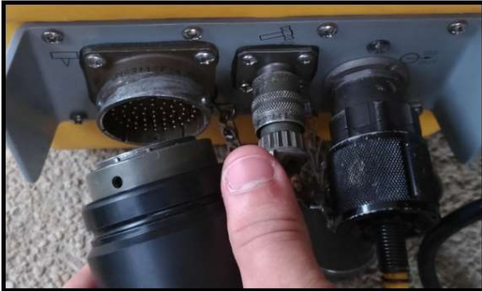
Imagen 27. Conexión cable Geode – Geostuff.
