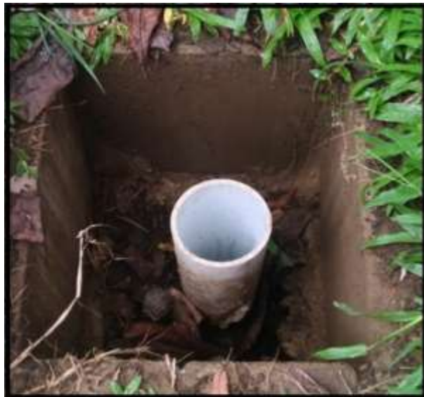
Imagen. 2. Sondeo en el cual se realizará el ensayo
