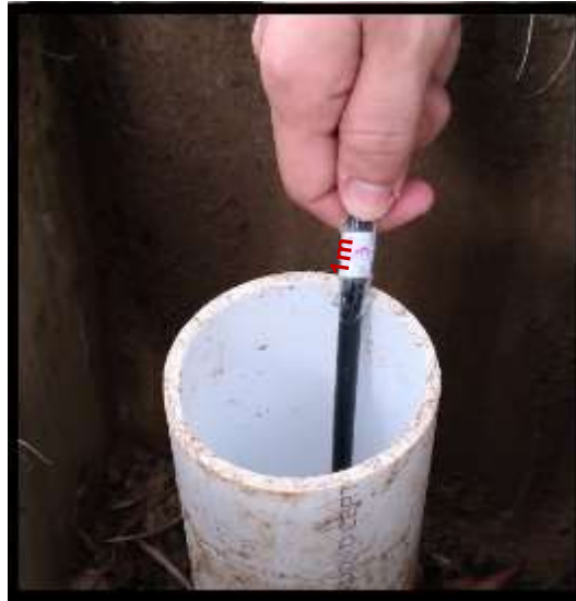
Imagen 37. Geófono en sondeo.
