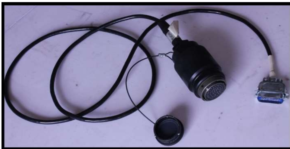
Imagen 14. Cable conexión Geostuff – Geode
