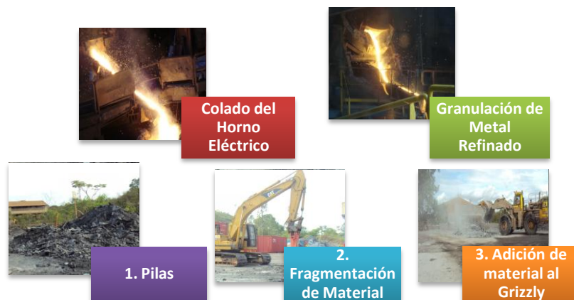
Figura 2. Descripción del procedimiento de almacenamiento, desintegración y fragmentación de las Pérdidas del proceso de colado y granulación.
