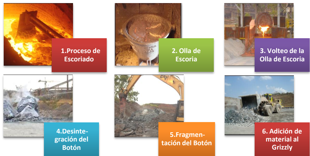
Figura 1. Procedimiento de almacenamiento, desintegración y fragmentación de la Escoria de la subfase de refinación.
