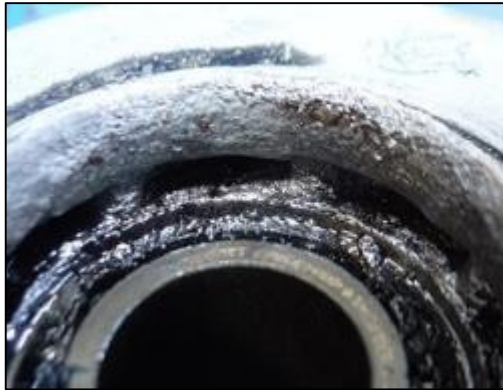
Figura 8: Obstrucción parcial de las trayectorias de flujo bomba electro sumergible del pozo P-4.
