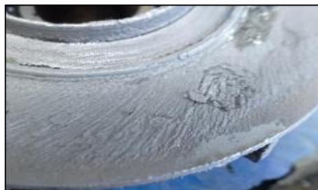
Figura 7: Impulsores de la bomba del pozo P-4 con acumulación severa de sólidos incrustantes.
