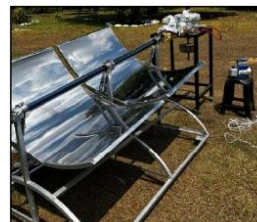
Fig 1. Banco de pruebas de destilación simple con energía solar
