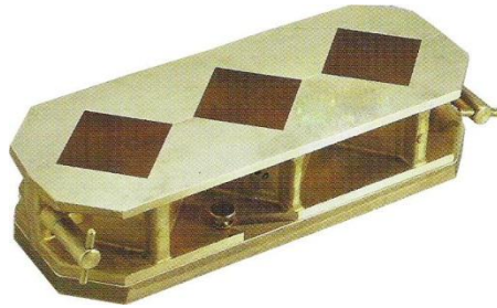
Figura 3. Moldes para cubos de cemento
