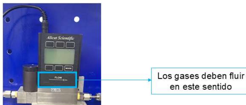
Figura 32. Sentido de flujo en los CFMs
