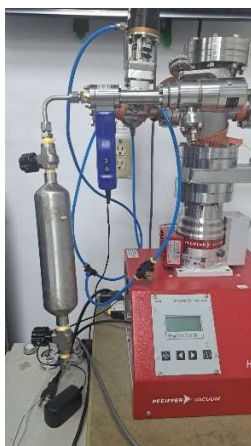
Figura 28. Conexión del cilindro al sistema de vacío
