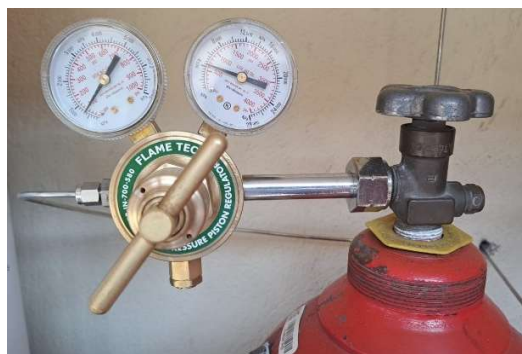
Figura 35. Apertura y regulación de presión de los gases puros
