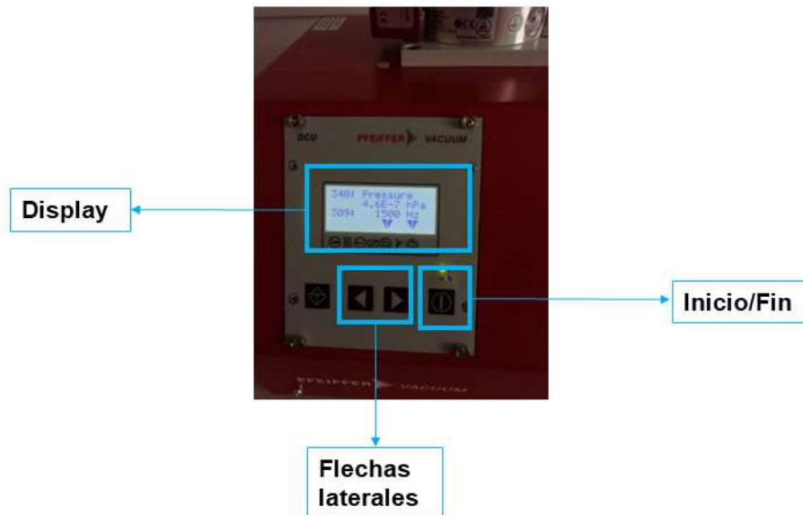
Figura 30. Panel de control del sistema de vacío
