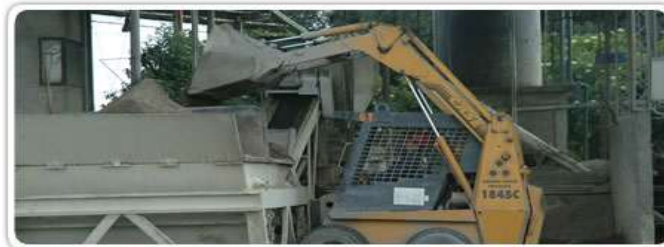
Figura 15. Cargado de las materias primas en la mezcladora
