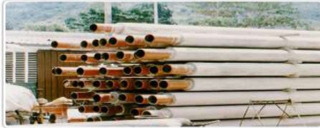
Figura 9. Lastrado de Tubería
