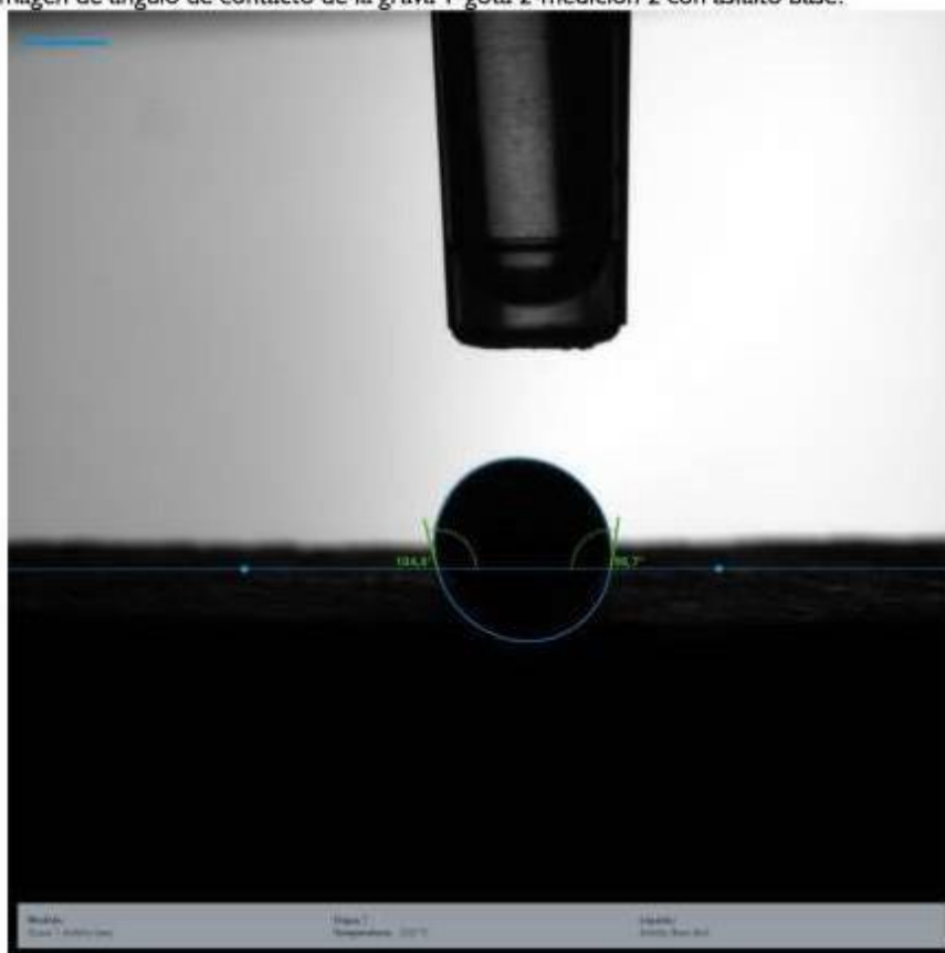
Figura 4: imagen de ángulo de contacto de la grava 1-gota 2-medición 2 con asfalto base.
