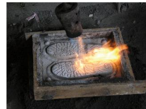
Figura 88: Copiado del molde en arena sílica
