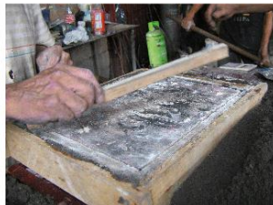
Figura 88: Copiado del molde en arena sílica
