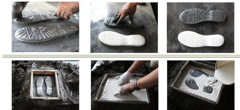
Figura 86: Sellado del modelo- Fabricación de molde en yeso
