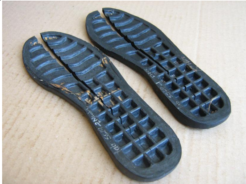
Figura 99: Muestras evaluadas a flexión en el Laboratorio CEINNOVA
