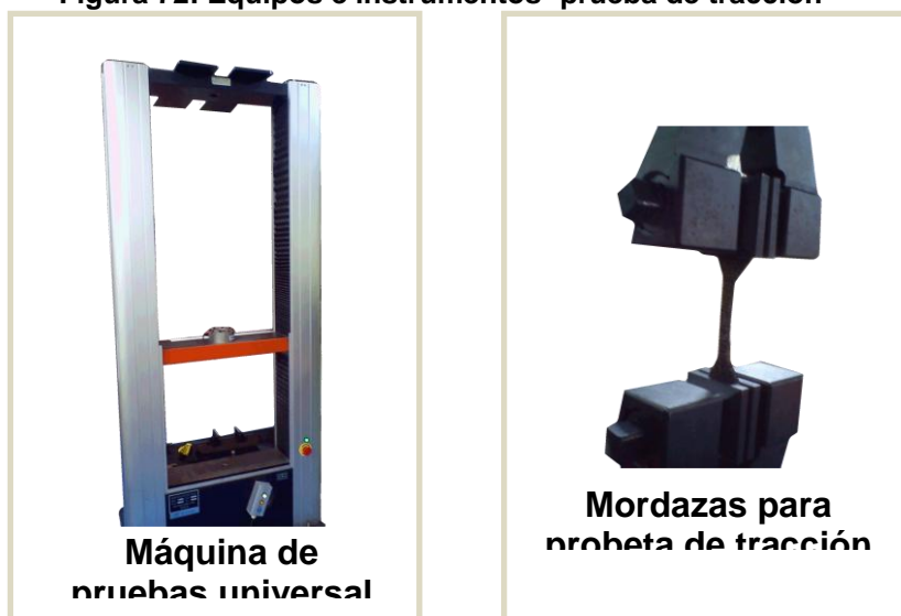
Figura 72: Equipos e instrumentos- prueba de tracción
