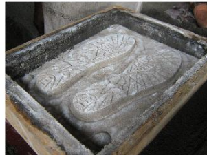
Figura 88: Copiado del molde en arena sílica
