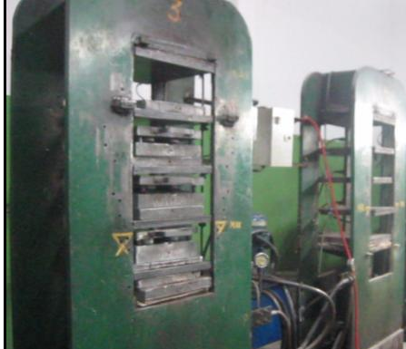
Figura 9: Prensa vulcanizadora para caucho
