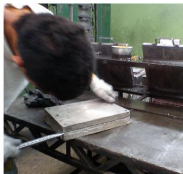
Extracción del molde de la prensa y apertura del molde para la extracción de las suelas
