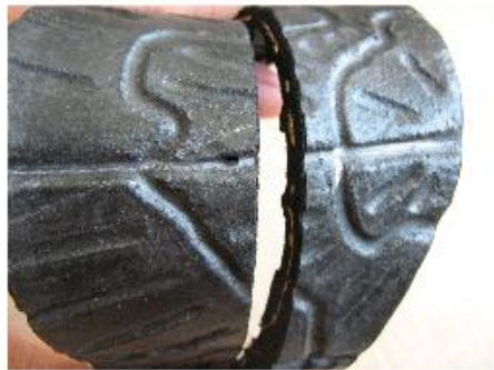
Detalle de la incisión para prueba de flexión SUELA CON REFUERZO DE MIMBRE - Incisión inicial: 2mm - La imagen muestra que la incisión se mantiene luego de la prueba de flexión
