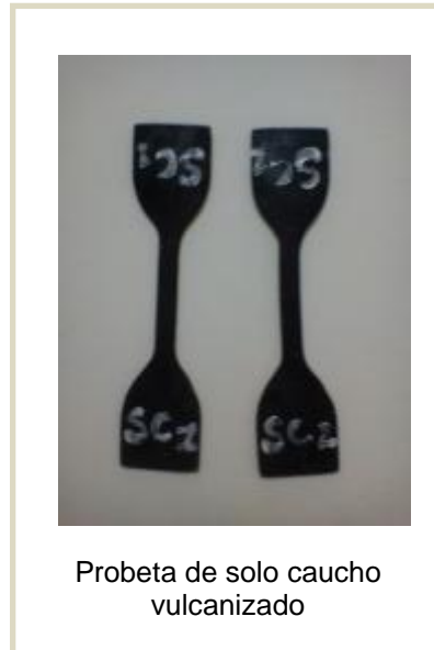
Figura 71: Probetas de tracción- Sin Refuerzo
