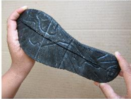
Muestra de suelas con refuerzo de fibras Prueba realizada con Equipo SATRA STM 465
