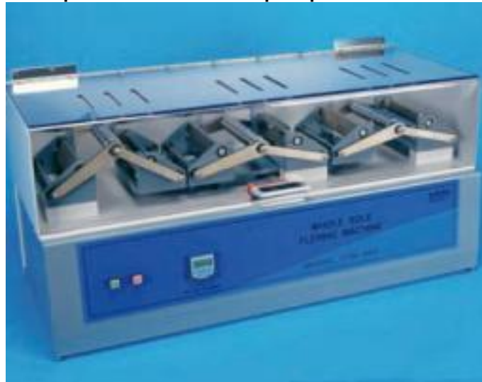
Figura 96: Maquina SATRA STM 465 para prueba de flexión en suelas
