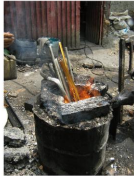
Figura 89: Proceso de fundición del Aluminio
