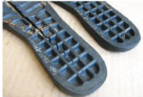
Muestra de suelas con refuerzo de fibras Prueba realizada con Equipo SATRA STM 465
