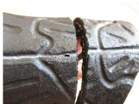
Detalle de la incisión para prueba de flexión SUELA CON REFUERZO DE FIQUE - Incisión inicial: 2mm - La imagen muestra que la incisión se mantiene luego de la prueba de flexión
