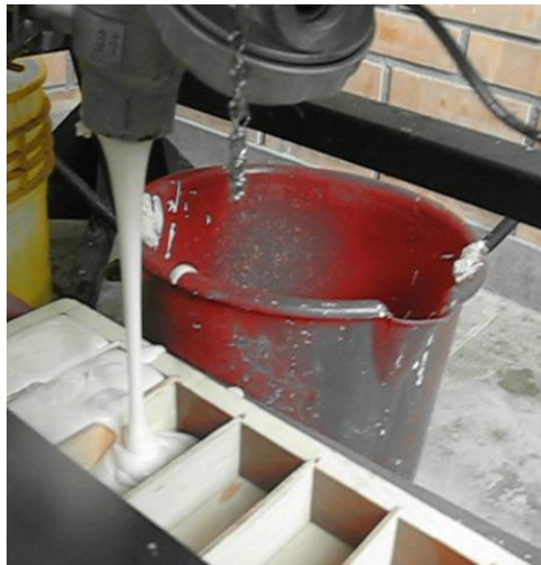
Iniciar flujo de jabón fundido
