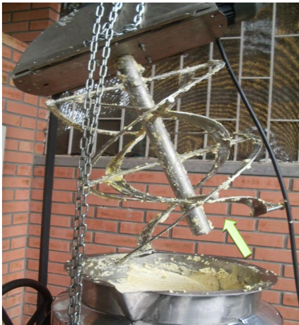
Foto 3: Sistema de agitación de planta.
