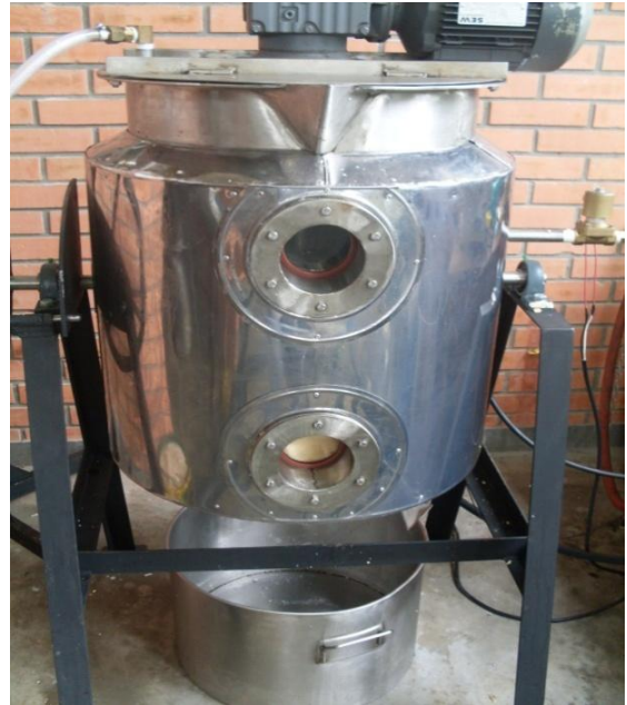
Foto 2: Reactor y tanque de glicerina.
