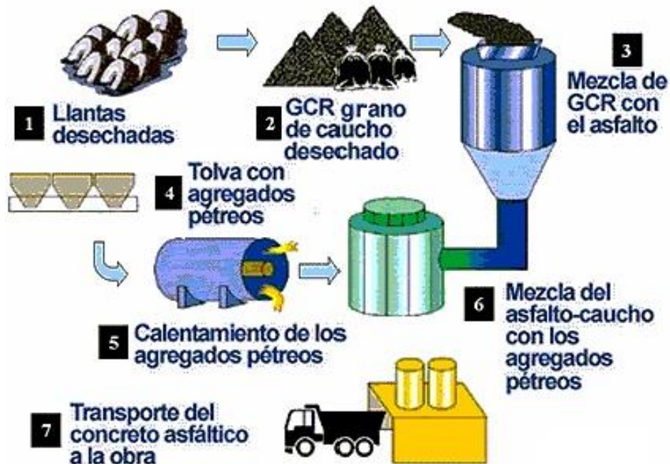
Figura 8. Proceso de modificación por vía húmeda. Adaptado de “Llantas usadas en pavimento”, por R, Bisso Fernández, 2010. Recuperado de http://ligante-asfaltico.blogspot.com/p/llantas-usadas-en-pavimentos.html
