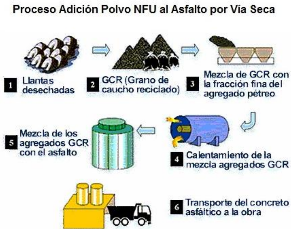
Figura 9. Proceso de modificación por vía seca. Adaptado de “Llantas usadas en pavimento”, por R, Bisso Fernández, 2010. Recuperado de http://ligante-asfaltico.blogspot.com/p/llantas-usadas-en-pavimentos.html
