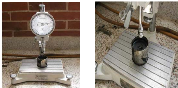
Figura 28. Ensayo de penetración
