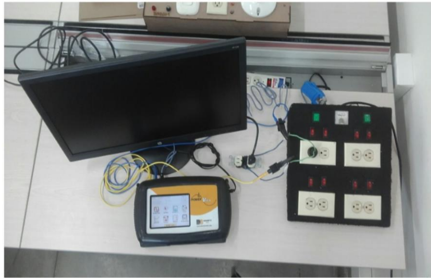
Figura 14. Medidor PowerVisa conectado a la carga a medir.
