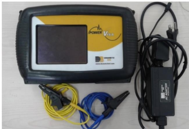
Figura 13. Medidor de la calidad de la energía PowerVisa.
