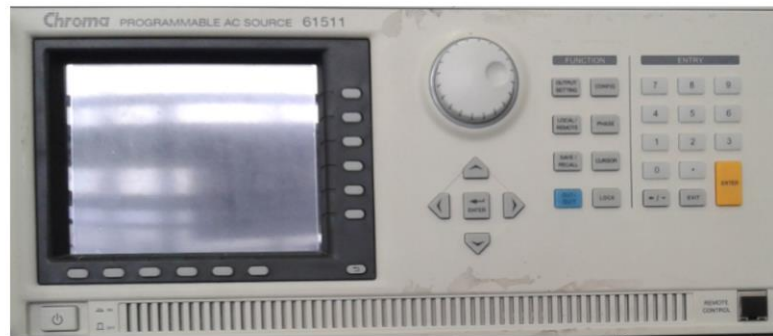
Figura 10. Imagen pantalla y botones de mando de la fuente programable Chroma.
