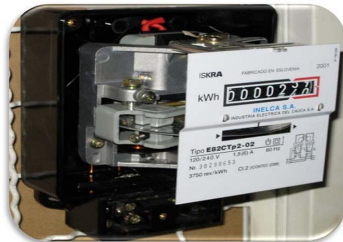
**3.4.2 Medidor electrónico con display ciclo métrico.** Es la mejora del medidor electromecánico, pero presenta display ciclométrico; entonces, cuenta con piñonería que es de fácil manipulación.
