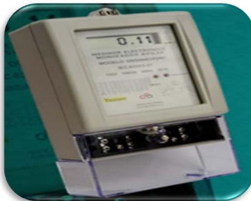
**3.4.4 Medidor en dos cuerpos.** Sistema cuyo objetivo es blindar la medida, dificultando el acceso al medidor principal donde se encuentran los dispositivos de medición; pero permitiéndole al usuario la visualización de los parámetros a través del repetidor o Display.
