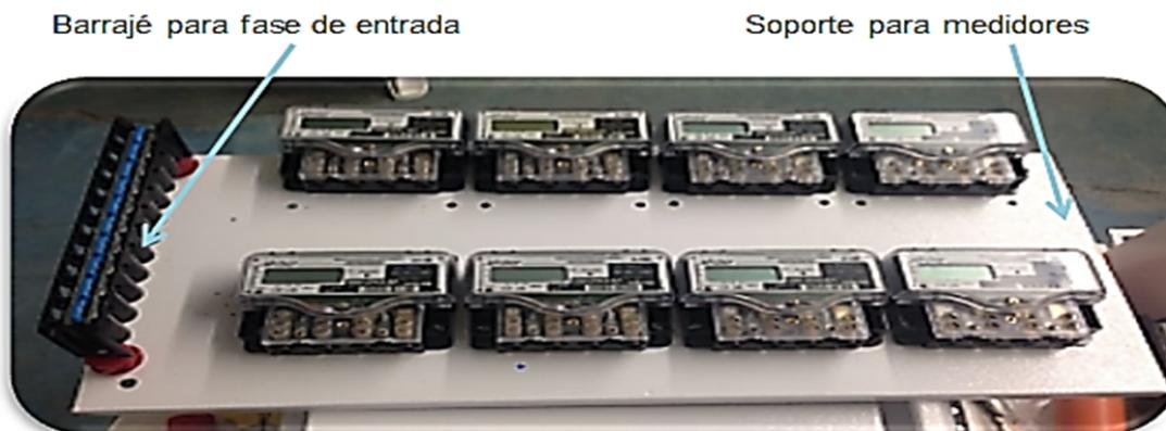
Se instala barraje en la fase de entrada sobre el aislador para generar altura y evitando que este tenga contacto con partes metálicas, para las líneas del neutro de entrada se instala a nivel de la base, esto con el fin de permitir la conexión de los medidores.
