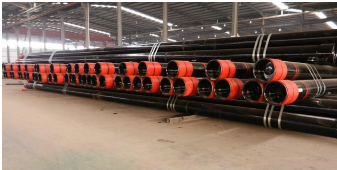
Figura 1. Tubería de revestimiento L-80 (9 5/8")
