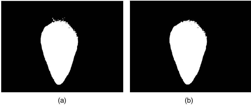
Figura 34. (a)Imagen resultante después de la apertura, (b) Imagen obtenida después de reducir áreas inferiores a 1000 píxeles.
