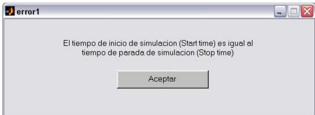
Figura 62. Mensaje de error presentado cuando los tiempos de inicio y parada de simulación son iguales
