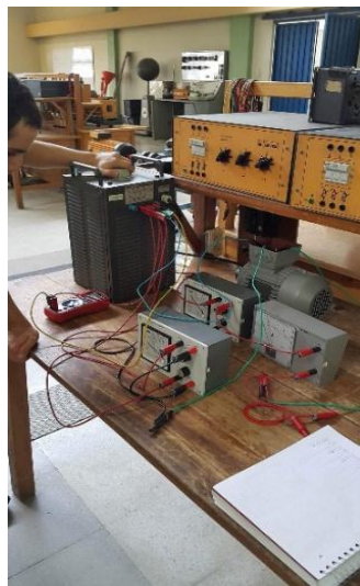
Figura 8 Montaje prueba en vacío
