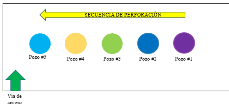
Figura 5. Secuencia de perforación de pozos en la Localización A.
