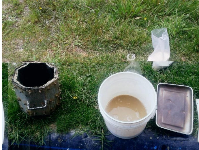
Fotografía 8. Eliminación de finos mediante el proceso de Lavado.
