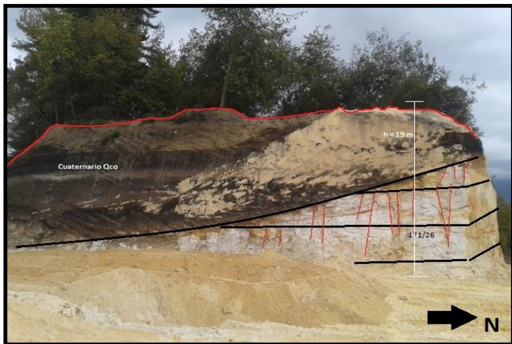
Fotografía 1. Panorámica Frente de Explotación Cárdenas. Contacto entre suelo franco arenoso y la unidad arenisca Tierna Nivel Inferior (Octubre 2014).
