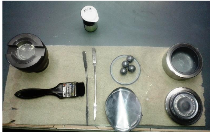
Fotografía 10. Implementos de Laboratorio para pulverizar la muestra.
