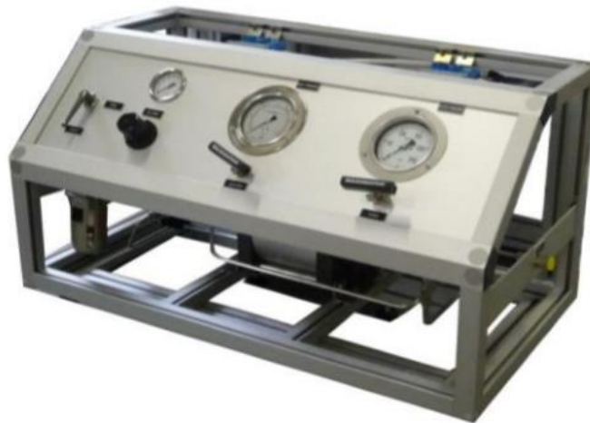
Figura 27 : Compresor de gas
