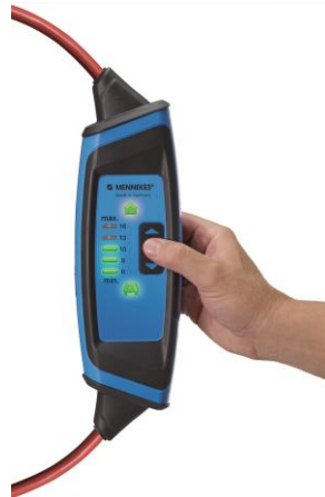
Figura 12: Cargador para modo 2, Permite seleccionar la intensidad de corriente.
