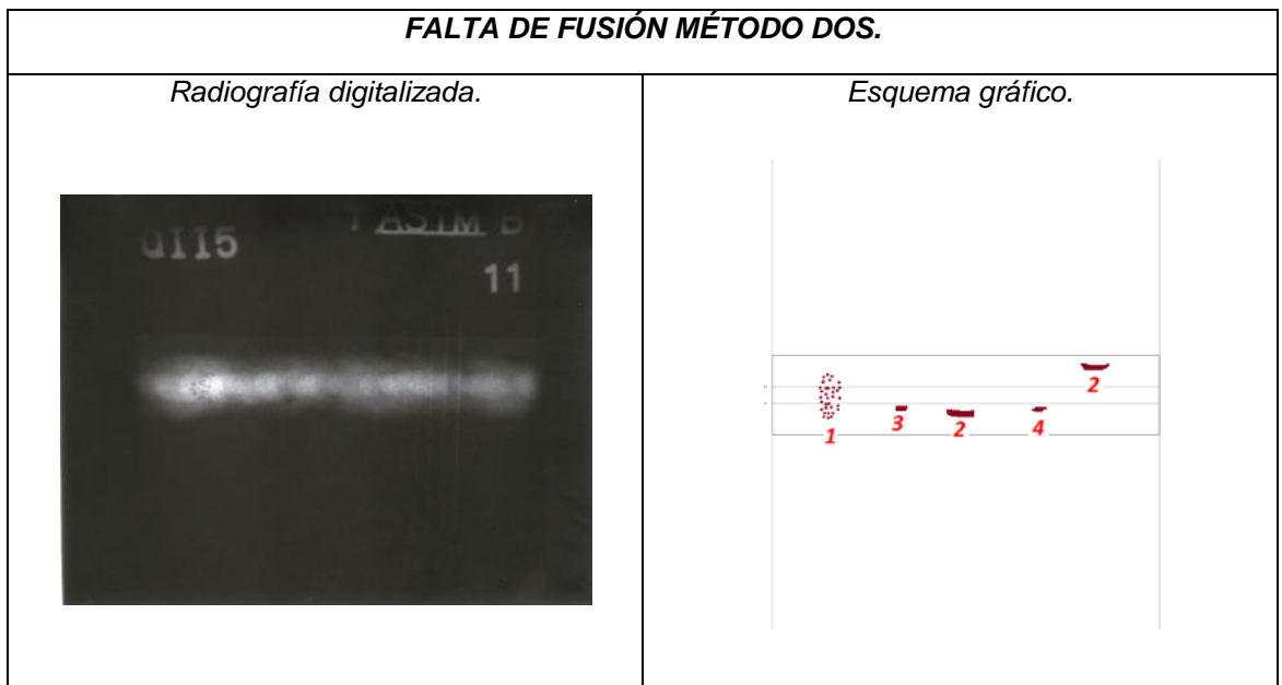
Figura 14. Radiografía digitalizada y esquema gráfico de la defectología de la probeta con falta de fusión generada con el método dos.
