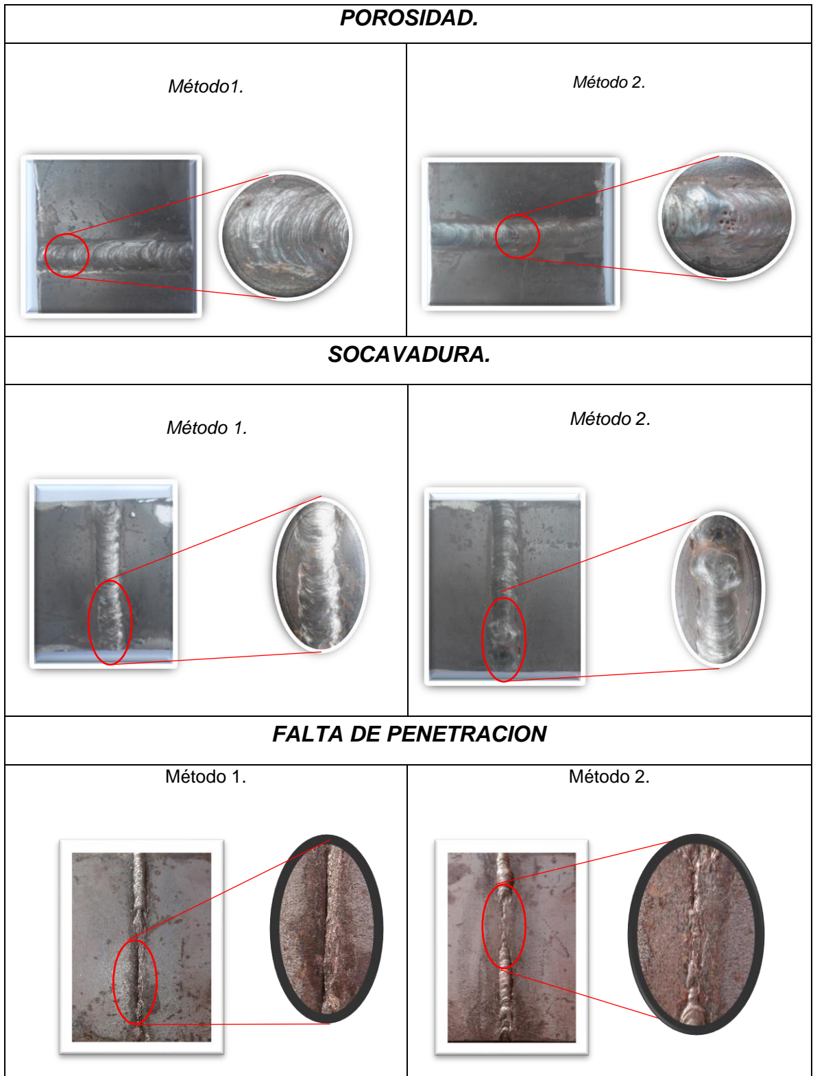
Figura 5. Imágenes fotográficas de probetas soldadas con defectología inducida visible.
