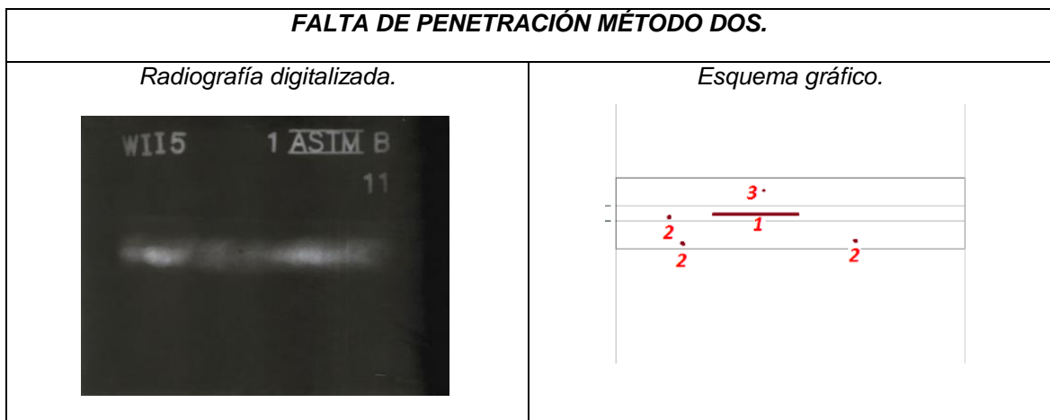
Figura 11. Radiografía digitalizada y esquema gráfico de la defectología de la probeta con falta de penetración generada con el método dos.
