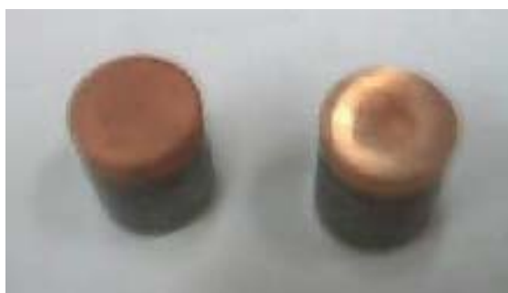
Figura 15. Probetas recubiertas con cobre: DC (izquierda) y PCR (derecha)
