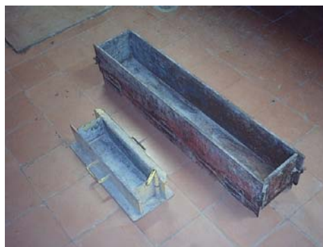
Foto 6. Formaletas para ensayos a flexión
