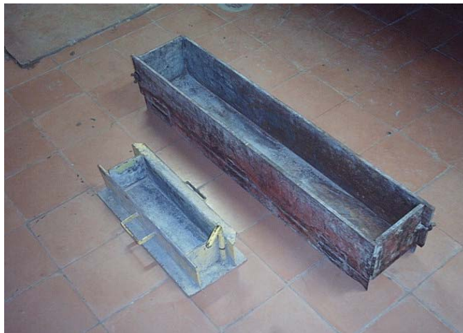
Foto 22. Formaleta para vigas
