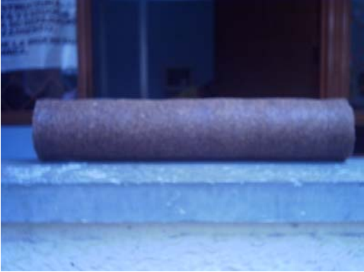
Foto 25. Posible aligeramiento para placas de entrepiso macizas
