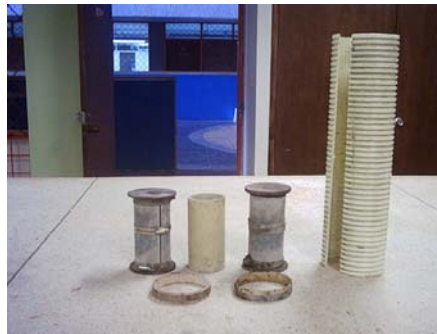
Foto 6. Formaletas para ensayos a flexión
