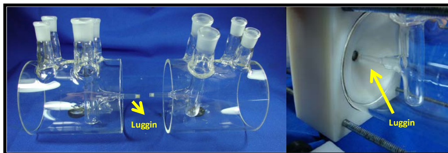
Figura 46. Celdas planas. Vista interior del tubo y posición frente a la muestra.
