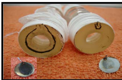
Figura 44. Estado final de la muestra después de la prueba de permeación.
