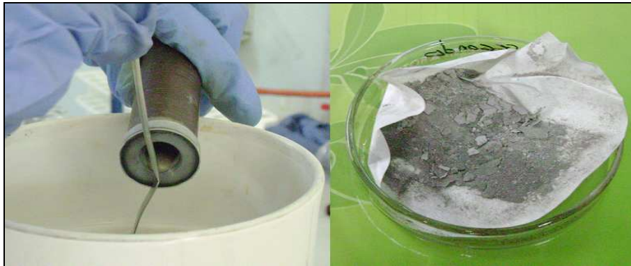
Figura 10. Filtración y secado del producto sintético
