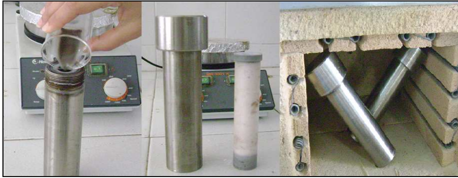
Figura 9. Calentamiento del gel de reacción
