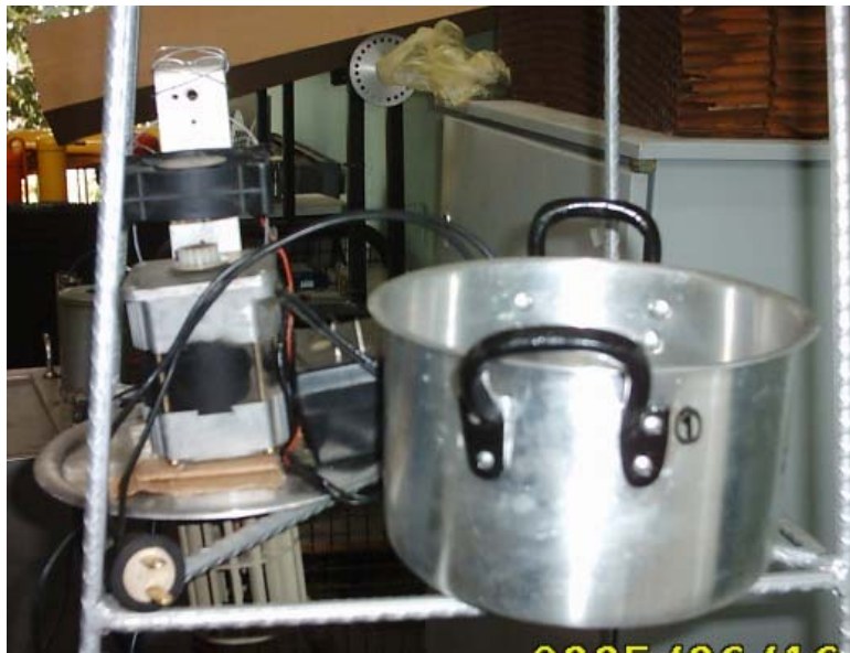
Figura 4. Reactor discontinuo y agitador fase experimental.
