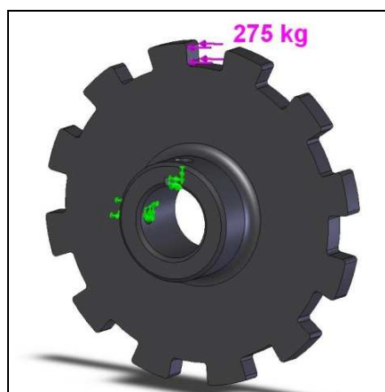
Figura 26. Condiciones de carga del disco con cubo y cuñero.
