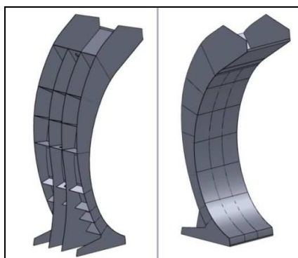
Figura 81. Unión armado interno y cubierta
