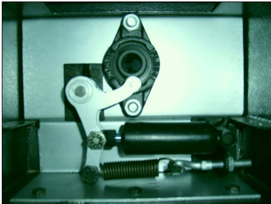
Figura 84. Ubicación de la platina inferior en la estructura
