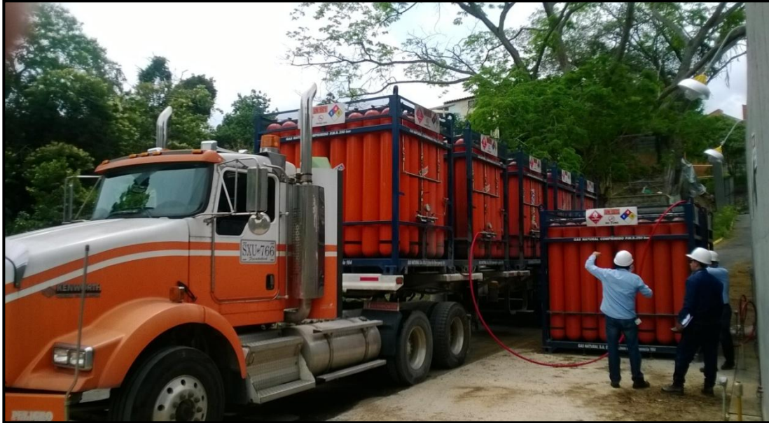
Figura 4. Fotografía de módulos de transporte y almacenamiento de gas
