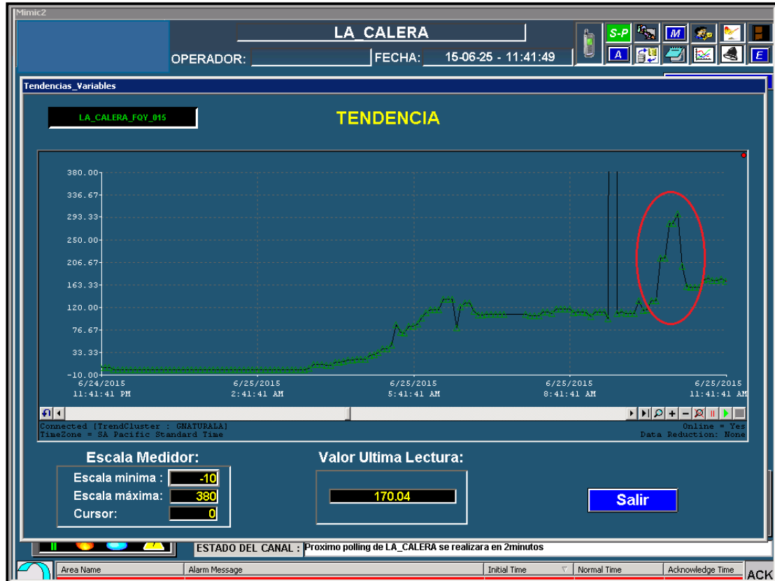
Figura 18. Flujo de gas en la estación descompresora de La Calera, registrado por el sistema Scada
