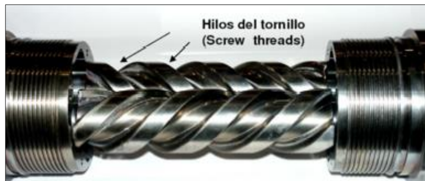
Figura 15. Etapa de una Bomba de Tornillo Gemelo.
