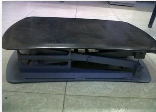
Figura 23. Sistema de Elevación.
