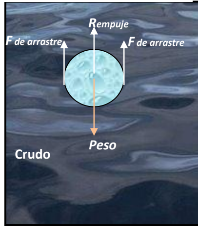
Figura 11. Esquema de la acción de las fuerzas sobre una gota de agua sumergida en un crudo
