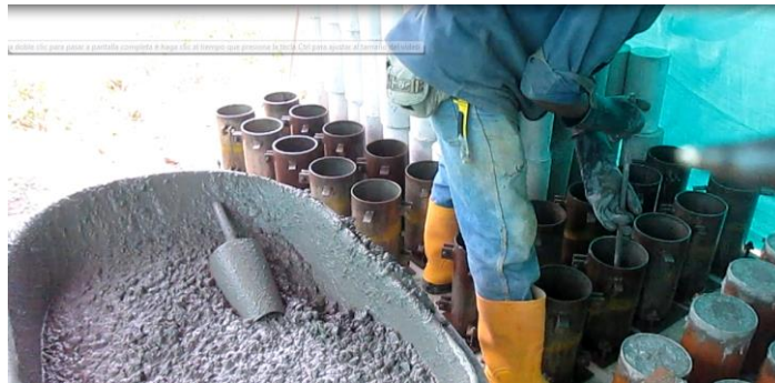
Figura 16. Elaboración de las probetas o cilindros de concreto.
