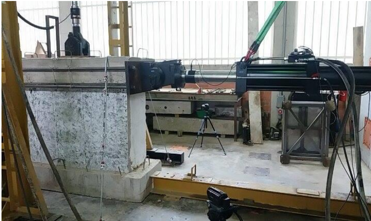
Figura 15. Montaje del muro en tapia pisada reforzado con un muro en concreto.
