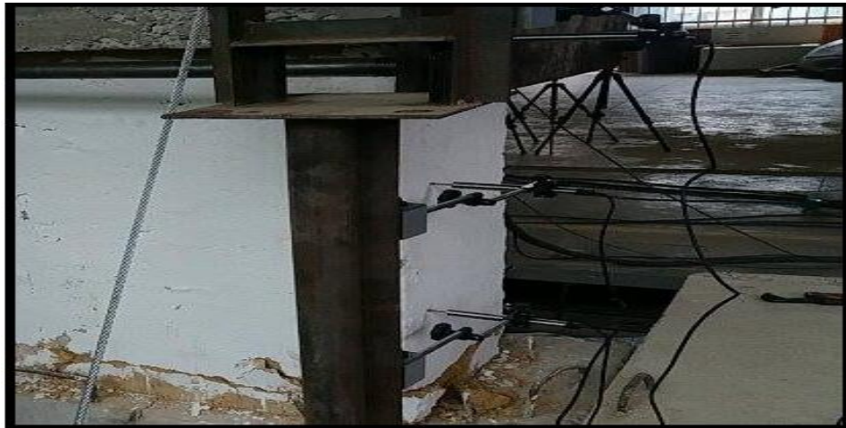
Figura 18. Imagen de extensómetros en el muro típico en tapia pisada en alturas de 35, 70 y 105 cm
