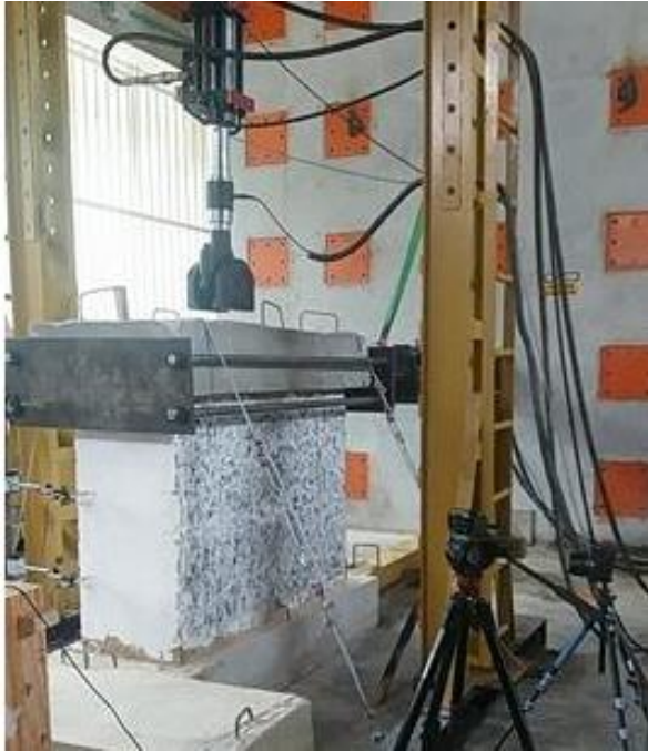
Figura 14. Montaje del muro en tapia pisada
