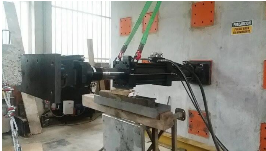
Figura 4. Actuador hidráulico (AH) encargado de aplicar la carga horizontal en el muro
