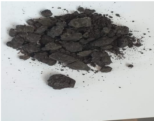
Figura 24. Estructura laminar y de bloques
