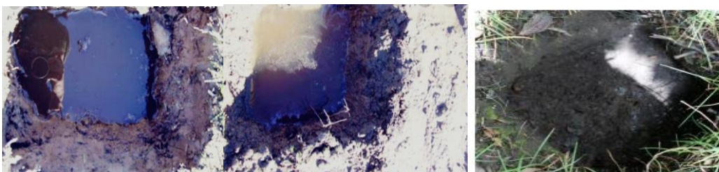
Figura 28. Determinación del drenaje
