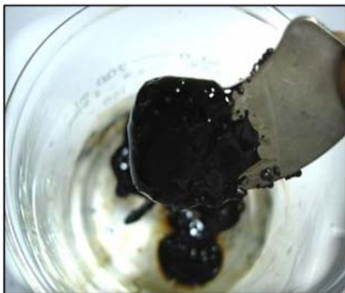
RECOLECCIÓN DE CRUDO MEDIANTE UN IMÁN DE NEODIMIO
