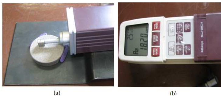
Figura 7. Medida de la rugosidad. a) muestra en el proceso de medida de la rugosidad superficial. b) Rugosímetro mitutoyo SJ-201.
