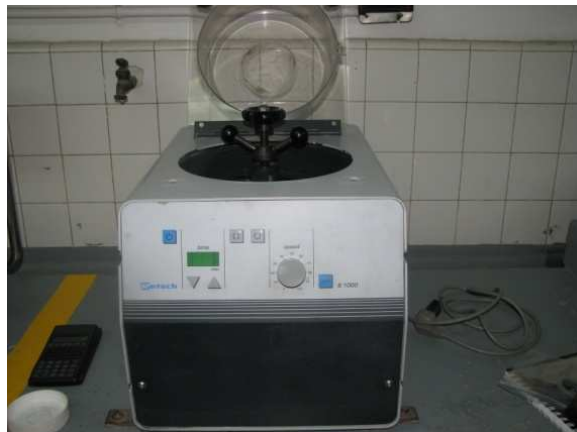
Figura 3. Molino centrífugo con bolas de circonia
