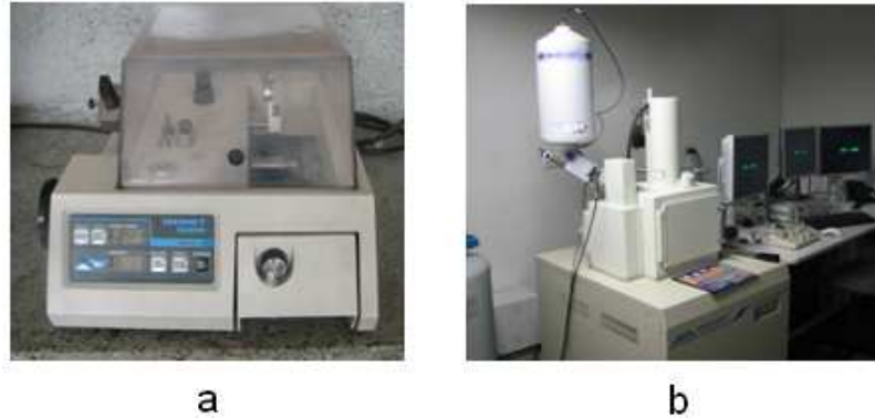
FIGURA 6. a) Cortadora ISOMET 1000, b) Microscopio Electrónico de Barrido.
