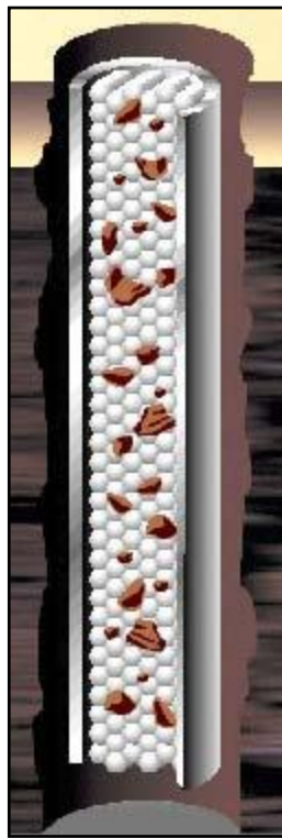
Figura 13. Transporte de Cortes con Espumas.
