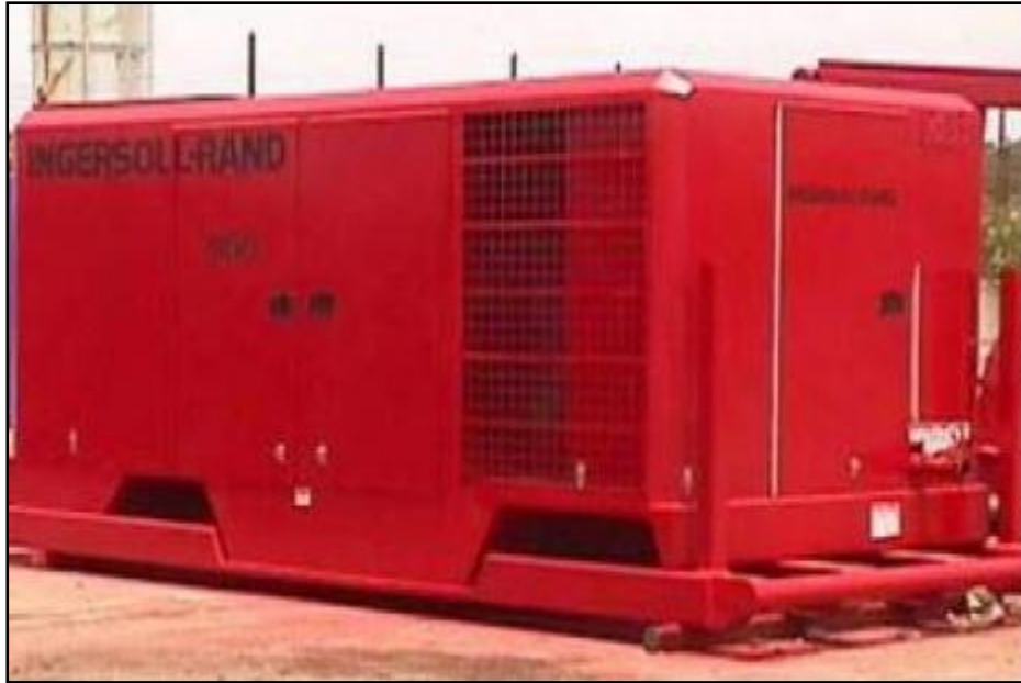
Foto 3. Compresor de Tornillo
