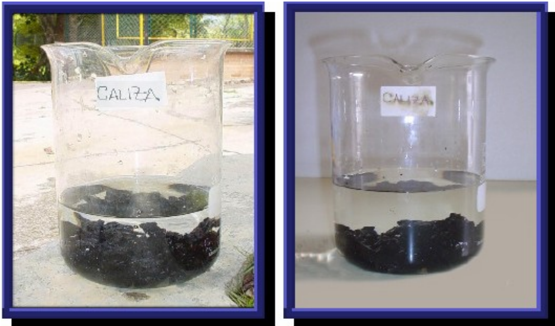
Figura 4. Mezcla con Caliza antes y después de la inmersión.
