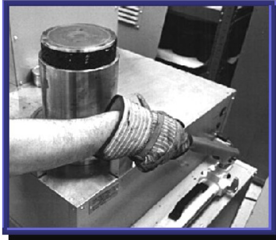
Figura 10. Extracción de la probeta compactada
