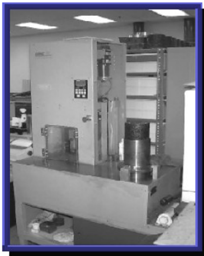
Figura 9. Molde con mezcla para compactar
