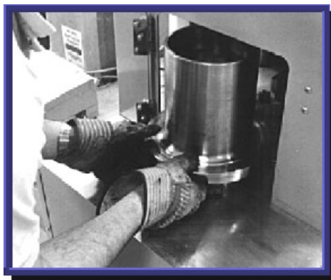
Figura 9. Molde con mezcla para compactar
