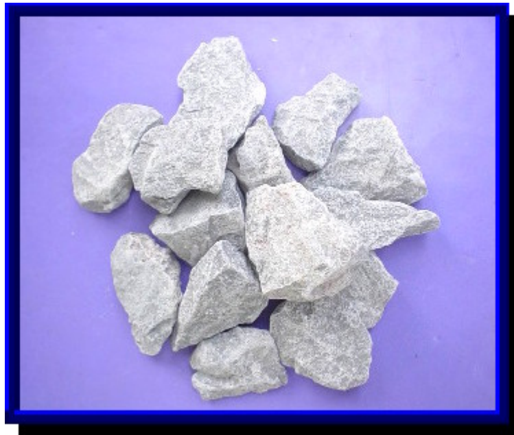
Figura 2. Agregado Hidrófobo (Caliza)
