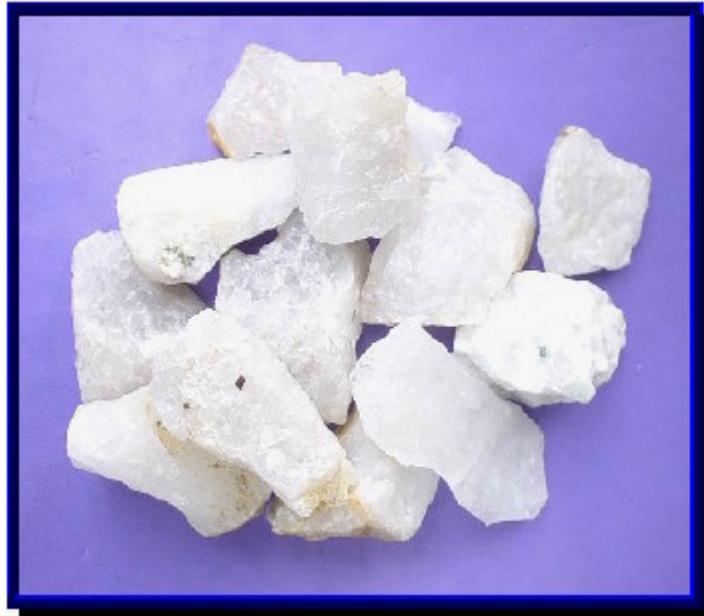
Figura 1. Agregado Hidrófilo (Cuarcita)
