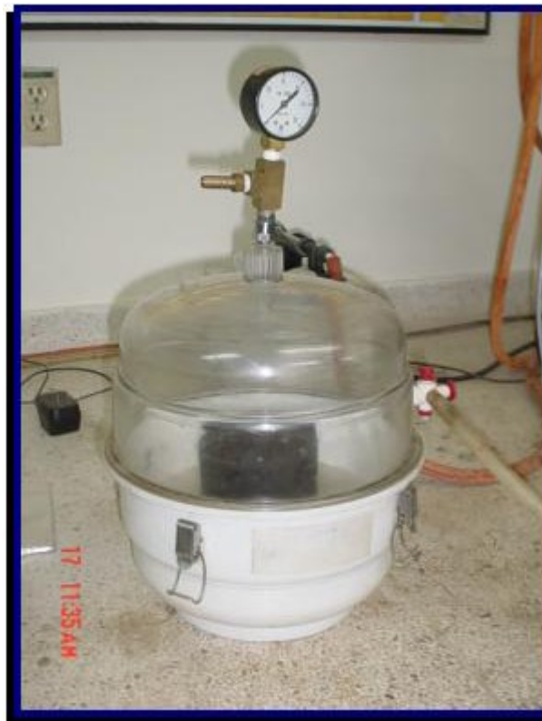
Figura 13. Cápsula de Saturación
