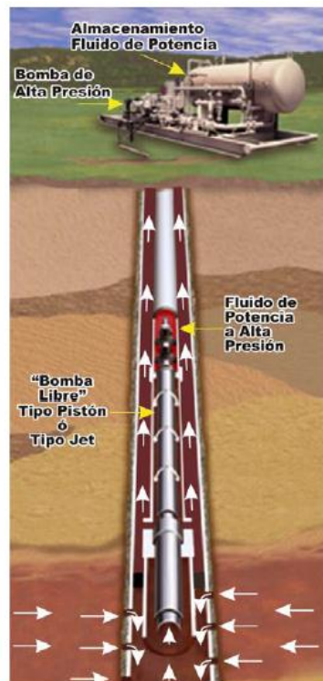
Figura 8. Esquema típico bombeo hidráulico tipo Pistón o Jet
