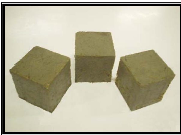
FOTO 27. Probetas tipo para fallar a la compresión.
