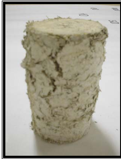
FOTO 24. Cilindro tipo fallado a compresión con 150 y 200 gramos de cemento en mezcla de bagazo con mortero de cemento.
