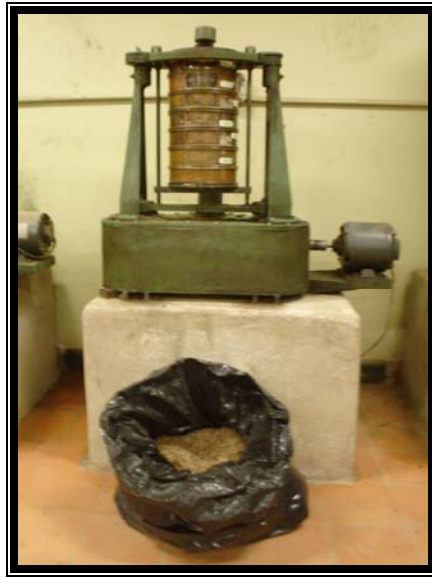
FOTO 10. Máquina vibradora de tamicez y tamicez. Laboratorio de suelos y pavimentos UIS
