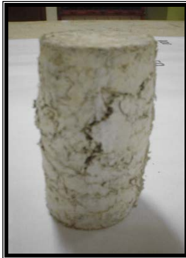
FOTO 26. Cilindro fallado a compresión con 250 gramos de cemento en mezcla de bagazo con mortero de cemento.
