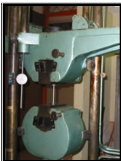
FOTO 28. Máquina universal de ensayos marca TREBEL. Laboratorio de resistencia de materiales.
