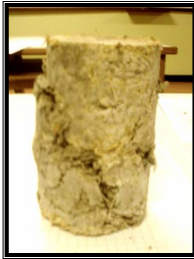
FOTO 25. Cilindro fallado a compresión con 300 gramos de cemento en mezcla de bagazo con mortero de cemento.
