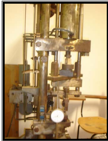
FOTO 18. Máquina universal de ensayos para maderas marca AMSLER Laboratorio de resistencia de materiales UIS
