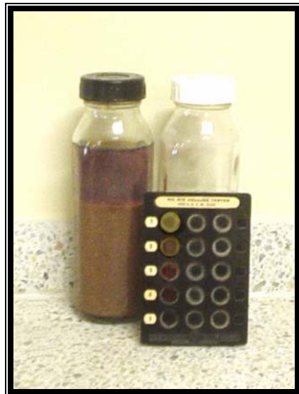
FOTO 17. Prueba de contenido de materia orgánica en la arena.
