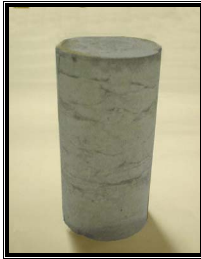
FOTO 21. Cilindro para prueba a compresión para cantidad de cemento en mezcla de bagazo con pasta de cemento.
