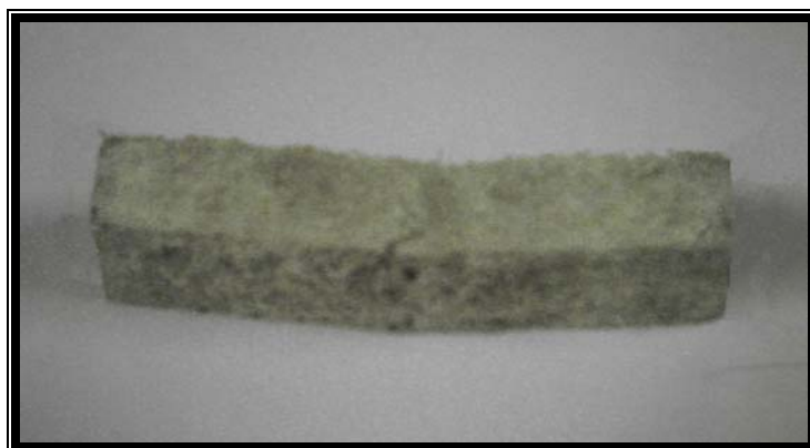
FOTO 34. Probeta tipo fallada a la flexión.
