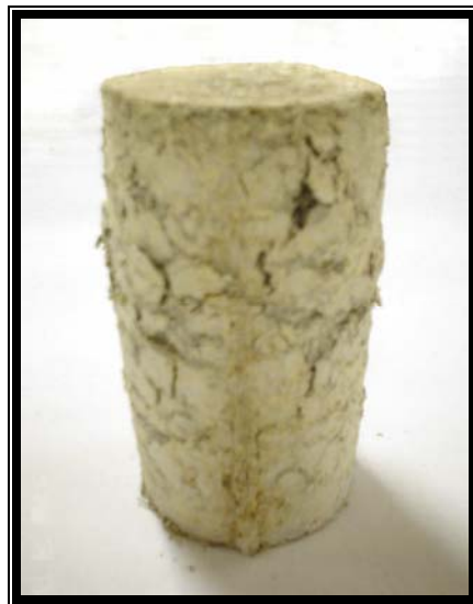
FOTO 22. Cilindro fallado a compresión para cantidad de cemento en mezcla de bagazo con pasta de cemento
