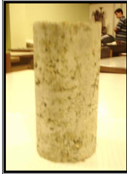
FOTO 23. Cilindro para prueba a compresión para cantidad de cemento en mezcla de bagazo con mortero de cemento
