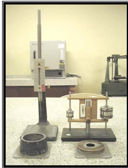
FOTO 16. Instrumentos para medición de tiempo de fraguado. Izquierda, aparato de Vicat. Derecha, agujas de Gillmore.
