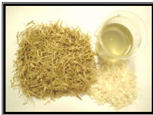
FOTO 14. Mineralización con Silicato de Sodio combinado con Sulfato de Aluminio
