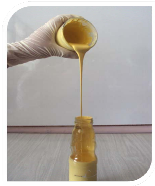
Figura 36 Prueba de Hilo pintura amarilla
