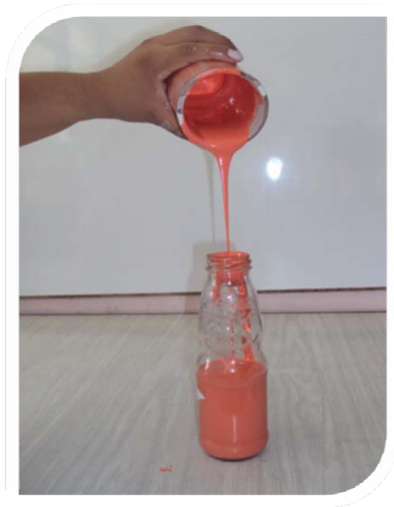
Figura 37 Prueba de Hilo pintura naranja
