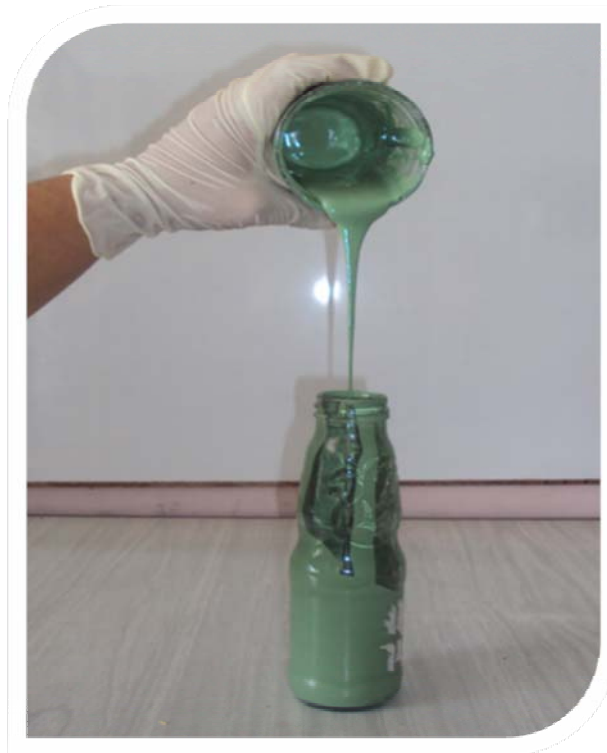
Figura 32 Prueba de Hilo pintura verde
