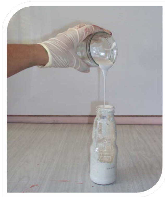
Figura 35 Prueba de Hilo pintura blanca
