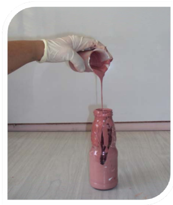
Figura 34 Prueba de Hilo pintura rosada
