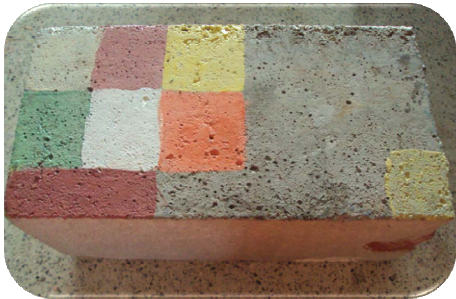
Figura 40 Aplicación de las pinturas en cemento
