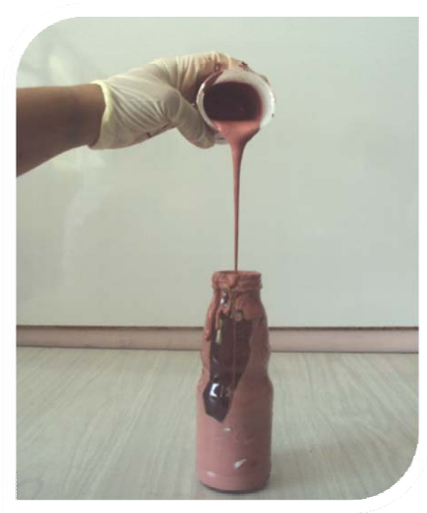
Figura 33 Prueba de Hilo pintura Roja
