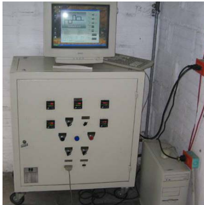
Figura 7. Rectificador de corriente utilizado en los ensayos de electrodeposición
