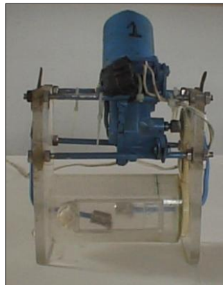
Figura 9. Fotografía del tambor rotatorio
