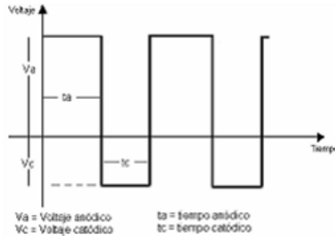
Figura 4. Diagrama de voltaje – tiempo para la técnica de corriente pulsante inversa
