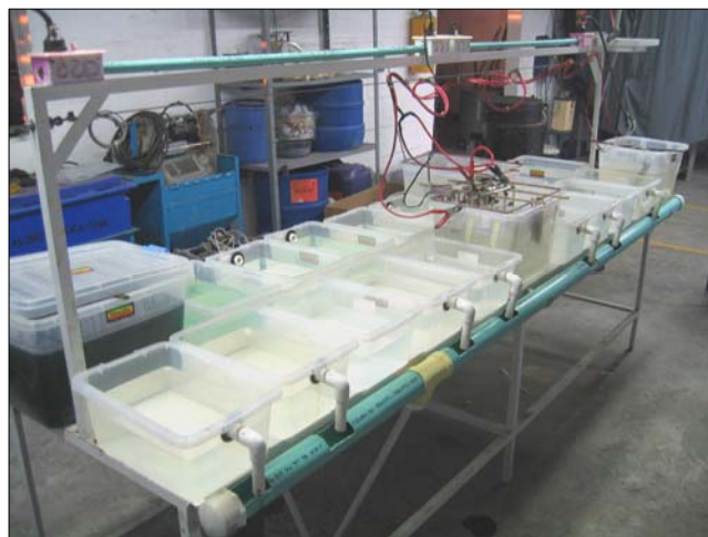
Figura 8. Montaje de baños electrolíticos para los procesos de electrorecubrimiento
