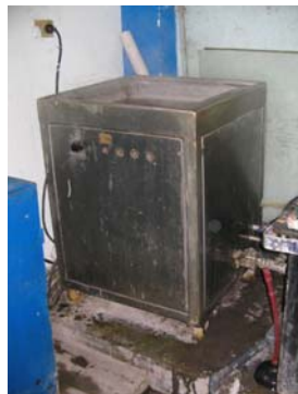
Figura 11. Equipo de desengrase por ultrasonido
